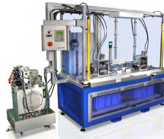
HYDRAULISCHE OFF-LINE AUSKLINK-STATION
