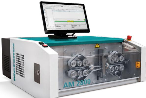
Serienmäßig verfügt die **Metzner AM 2800** über einen 2-fach Schneidkopf und einen gefederten Bandvorschub zum automatischen Ausgleich von Materialschwankungen.
