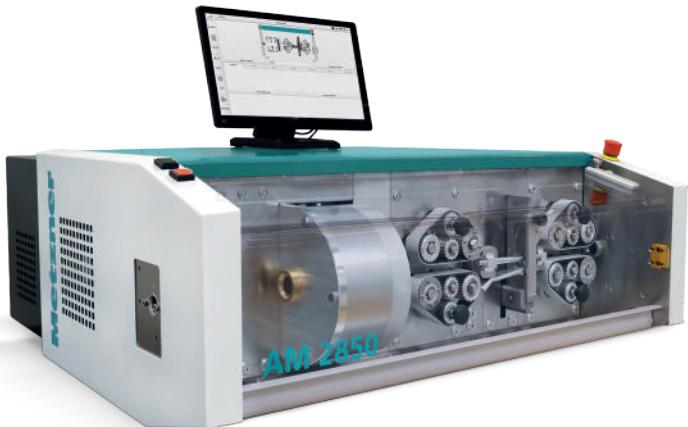
Die **Metzner AM 2850** kombiniert alle Vorteile der AM 2800 mit den zusätzlichen Bearbeitungsmöglichkeiten eines Rotationsmoduls für Koaxialkabel und Mehrlagenbearbeitung.
