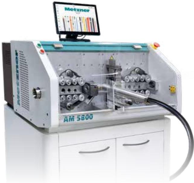
Die Metzner AM 5800 bietet mit ihren extra langen Transportbändern eine hervorragende Wiederholgenauigkeit. Ihr Doppelmesser-Schneidesystem ermöglicht mehrere Bearbeitungsschritte gleichzeitig.
