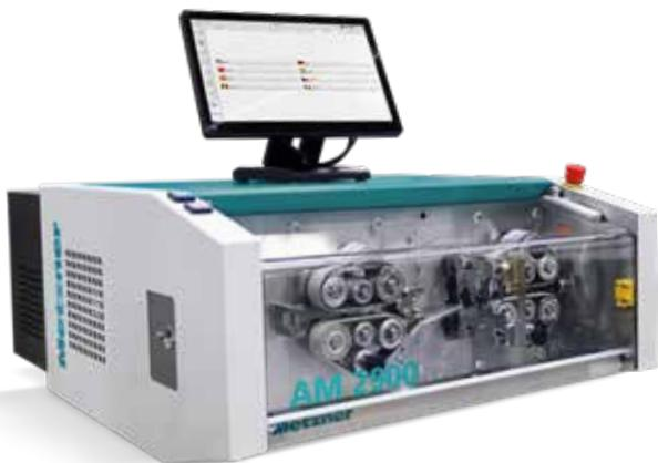
Die Metzner AM 2900 erweitert die AM 2000 Baureihe um ein Mehrfach-Messermodul und ermöglicht dadurch vielseitige Bearbeitungen mit bis zu drei Messerpaaren in einem automatischen Prozess.
